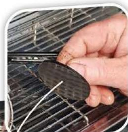
... Prendre un porte filtre, **y déposer le filtre aveugle et une pastille de nettoyage**. Positionner le porte filtre sur le groupe café et **lancer un cycle de café pendant 5 secondes**, arrêtez et répétez cette opération plusieurs fois.
